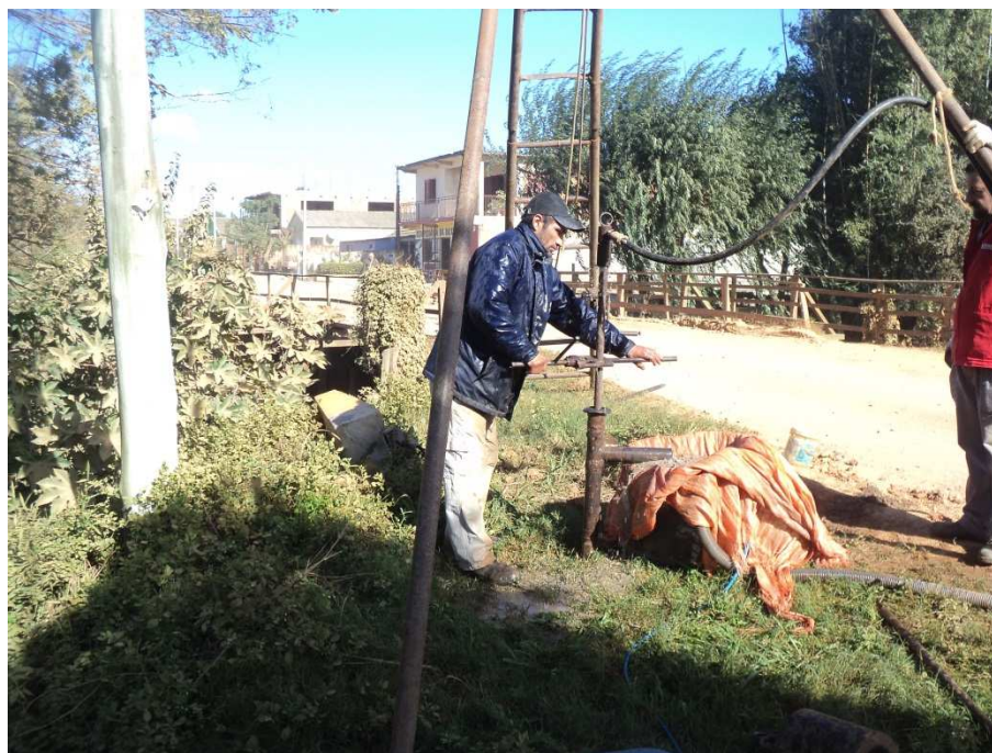
Figura 2.6 – Execução do furo SPT-02 (margem esquerda)
