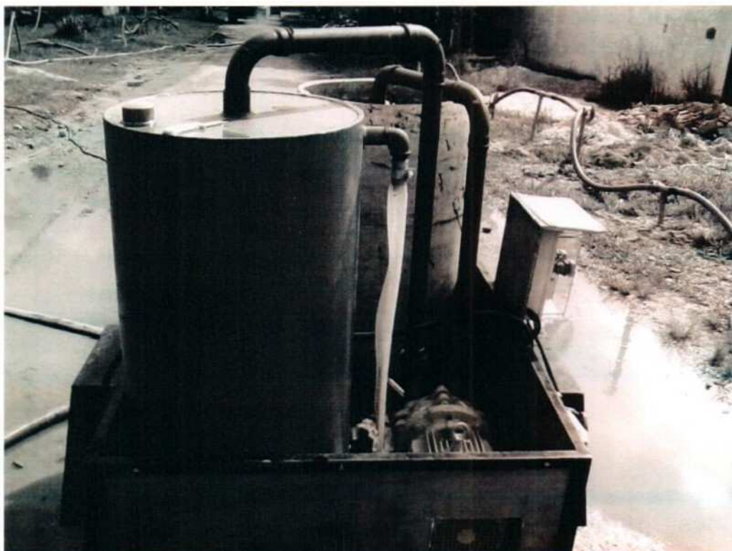
Figura 3.1: Detalhe do Sistema de Rebaixamento "à vácuo"
