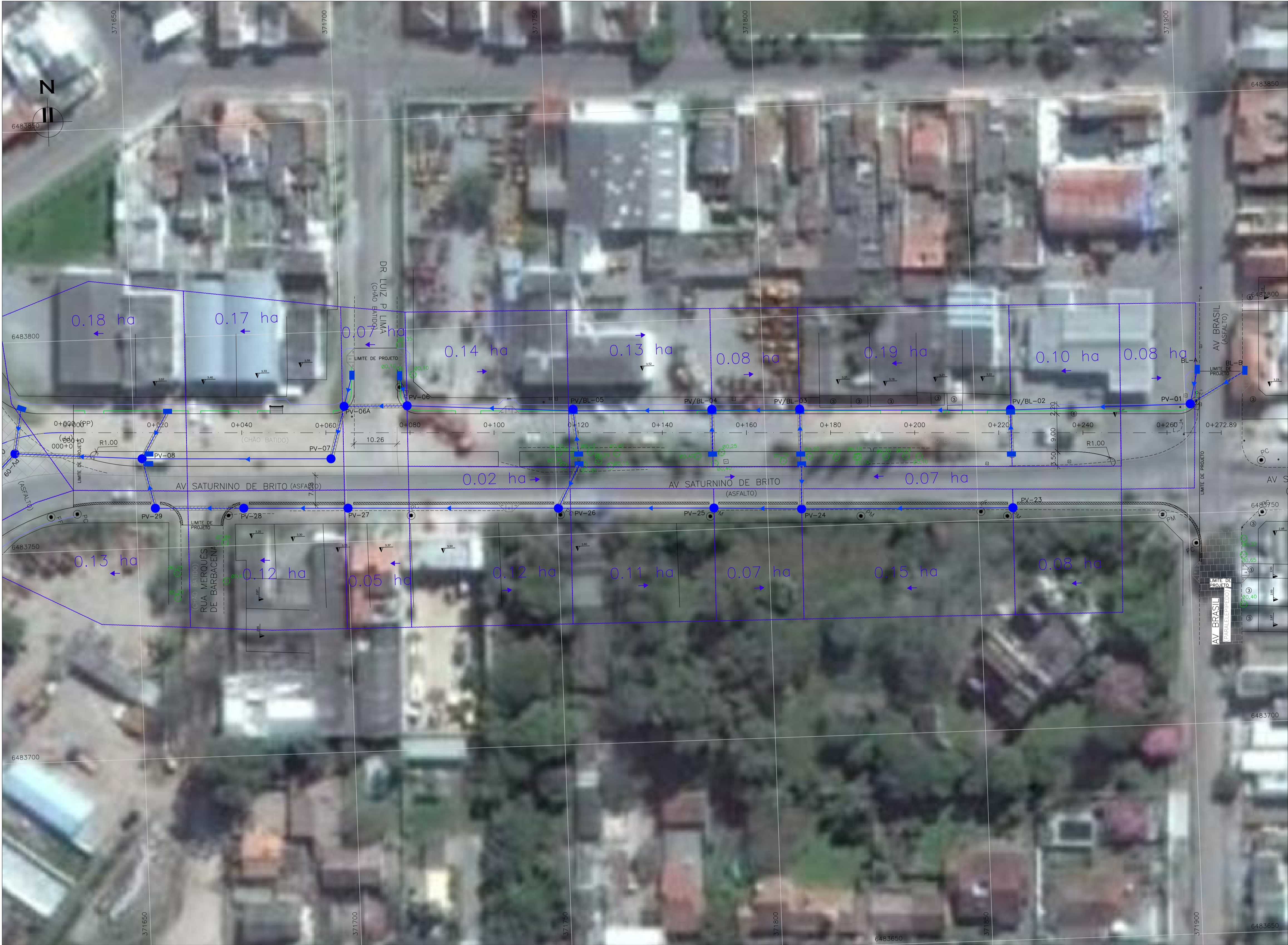
PROJETO DE DRENAGEM – PLANTA BAIXA ESCALA: 1:500 (A1) / 1:1000 (A3)
