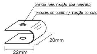
OBS: O furo Ø8mm permite sua fixação sobre as hastas rosqueadas que fixam a própria telha com porca Ø1/4"
