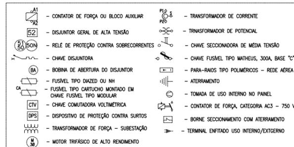
SIMBOLOGIA DO ESQUEMA UNIFILAR SEM ESCALA
