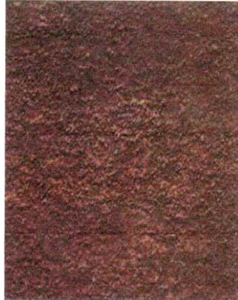
**Grau D** – superfície de aço onde já se apresenta corrosão acentuada com presença de *pits* e alvéolos.
