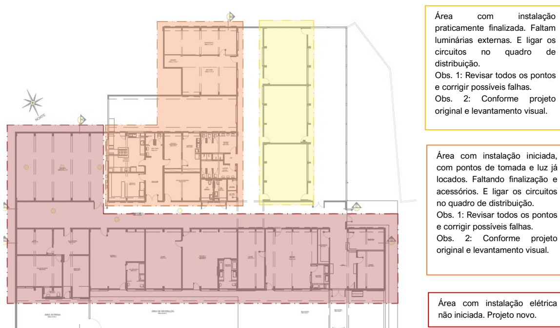
Figura 20: Níveis de acabamento das instalações elétricas.
