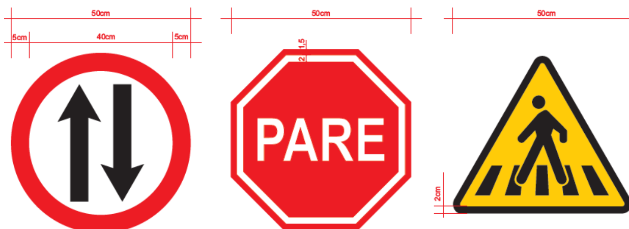
Figura 88 - Placas de Advertência (Detalhe)
