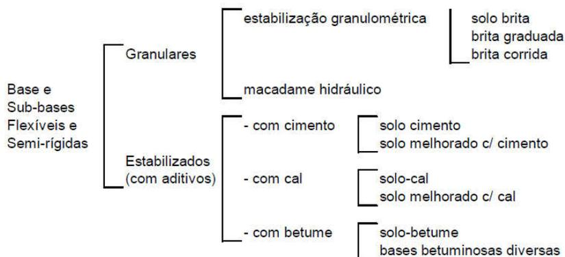
Figura 4- Classificação das bases e sub-bases.
