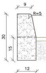
Figura 4 - Detalhe do meio-fio utilizado neste projeto
