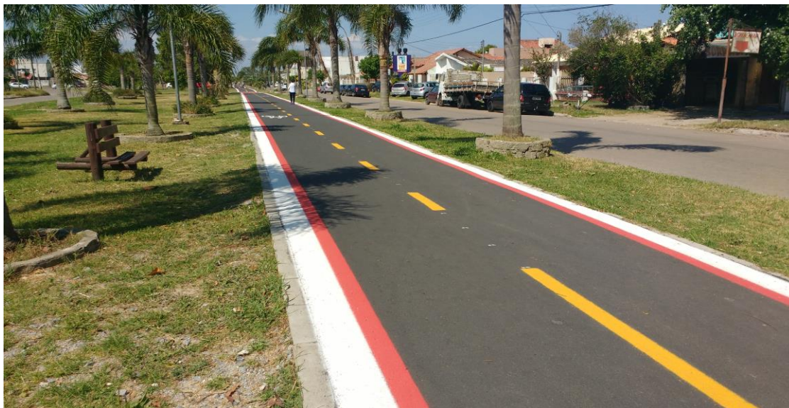
Figura 11- Exemplo de sinalização horizontal executada na ciclovia da Av. Rio Grande, em Rio Grande.
