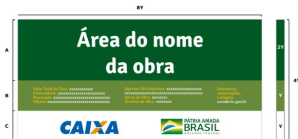
Figura 1 – Modelo de Placa de obra, conforme Manual CAIXA
