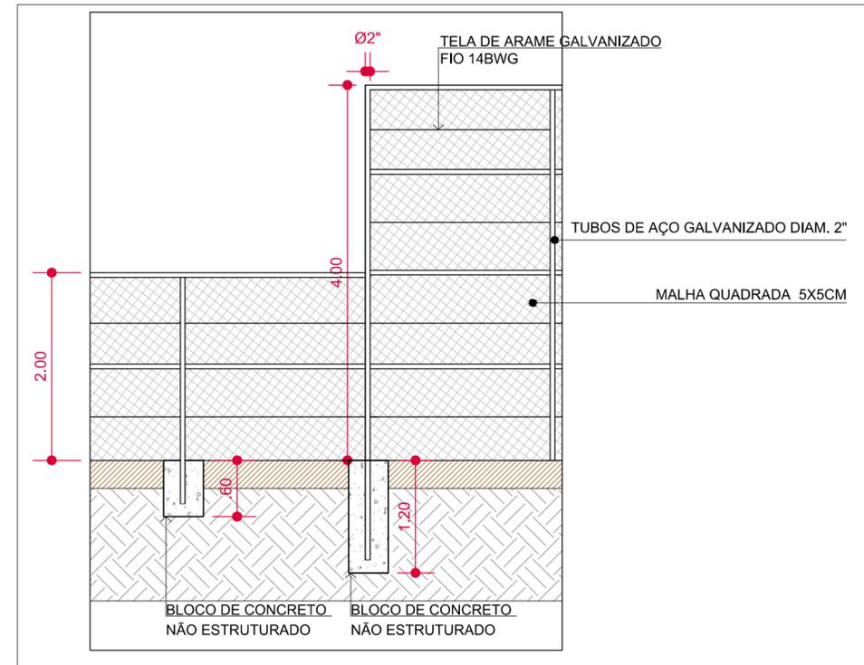
**02** DETALHE FIXAÇÃO DO ALAMBRADO
